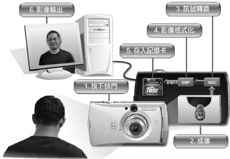
圖 1：相機曝光原理過程
